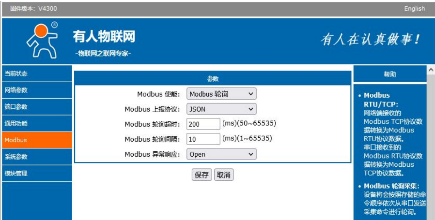
图 31. Modbus 协议轮询采集功能设置
