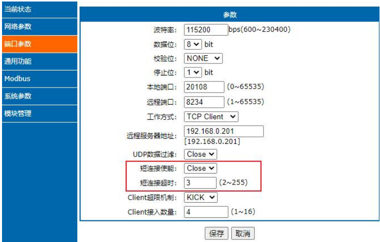
图 10. 短连接设置图示
