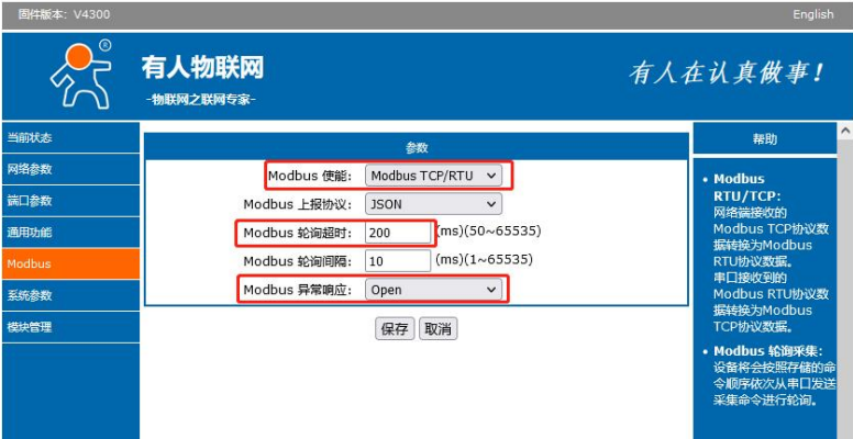
图 28. Modbus 协议转换功能设置
